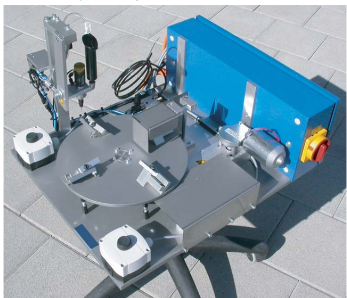
Klebestation mit Rundtakttisch und Zweihandauslösung.
