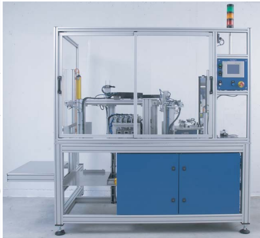
Montageanlage für Baugruppen mit Prüfstation und Sortierung.
