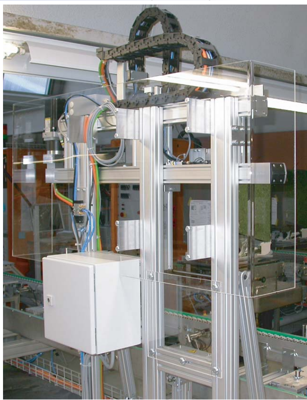
Prüfanlage mit Servoachsen für grosse Produkte auf Werkstückträger.
