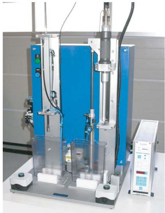
Ultraschallschweissanlage mit Druckprüfung.
