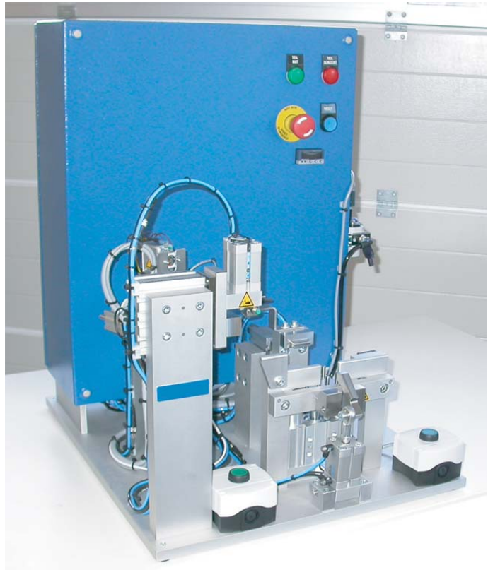
Montagestation für Baugruppe mit Heisspräger.
