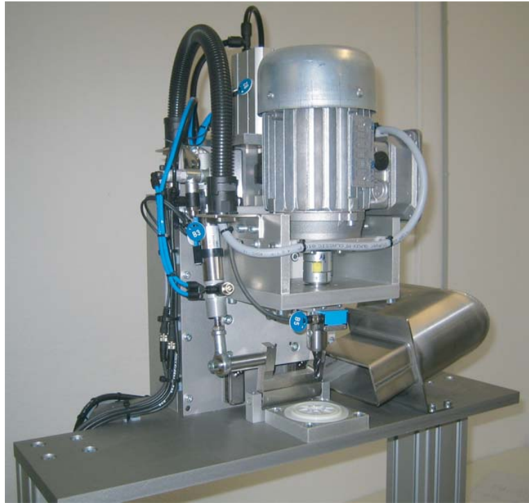
Frässtation für Glasfaserteile mit Absaugung.
