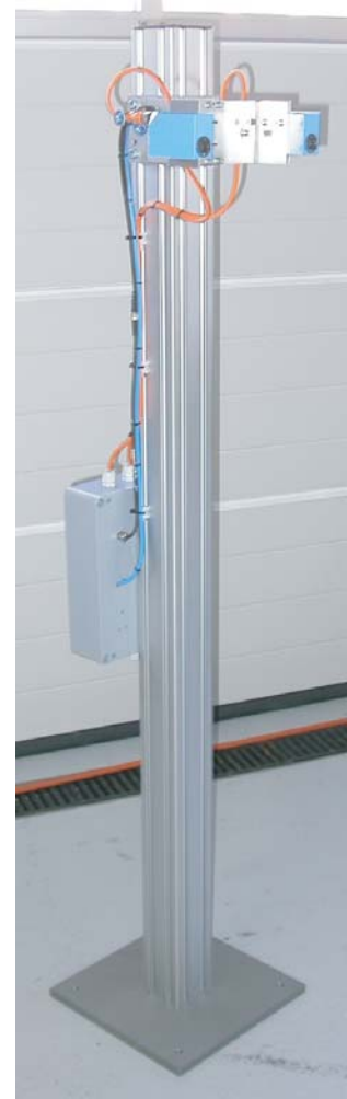
Sensorständer mit Klemmenbox und Farberkennungs- sensor.
