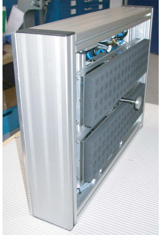
Vakuumgreifer für Kartonboxen mit Höhentaster und Suchsensoren.
