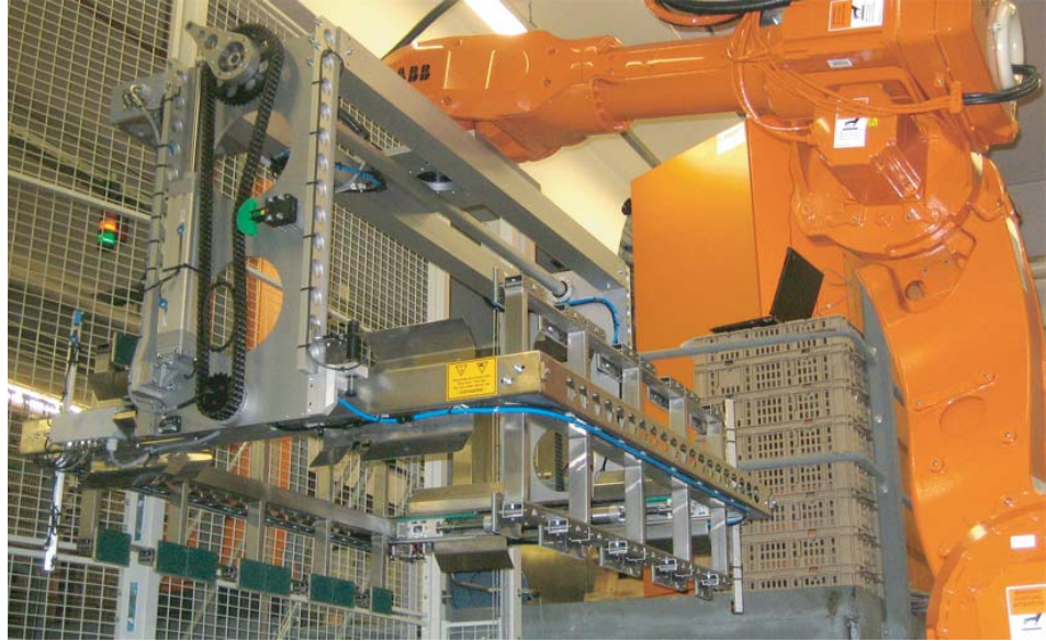
Wendegreifer 180° für Gebinde mehr- lagig und Paletten einlagig. Grösse 1200x600mm.
