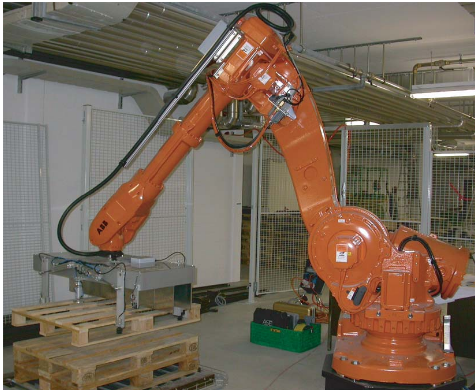
Kartongreifer mit Einzelklemmbacken bis zu Halblagen für Kartonboxen, Zwischenlagen und Paletten.
