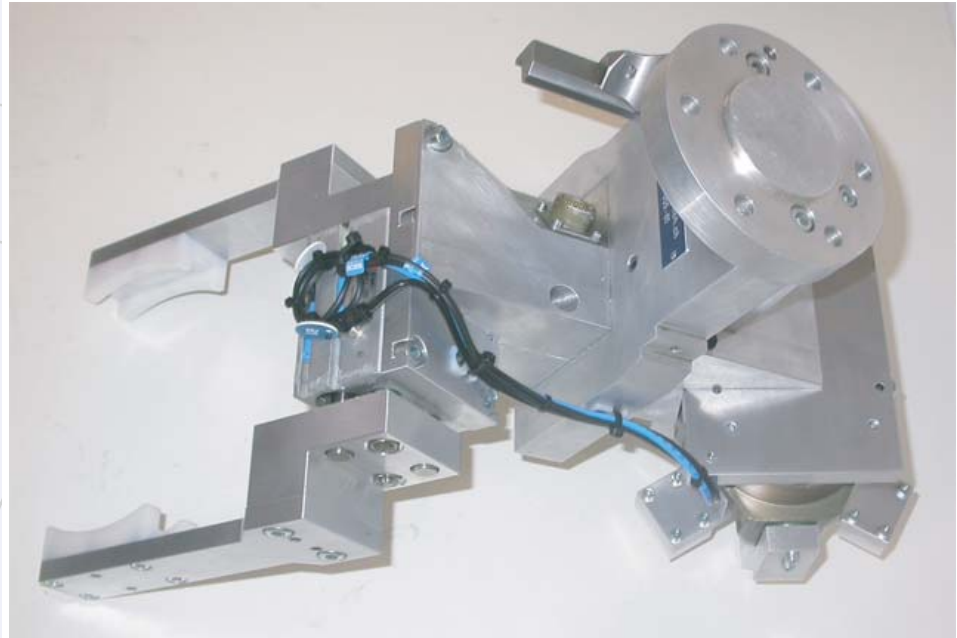
Einlege- und Entnahmegrifer für Alu-Ringe.
