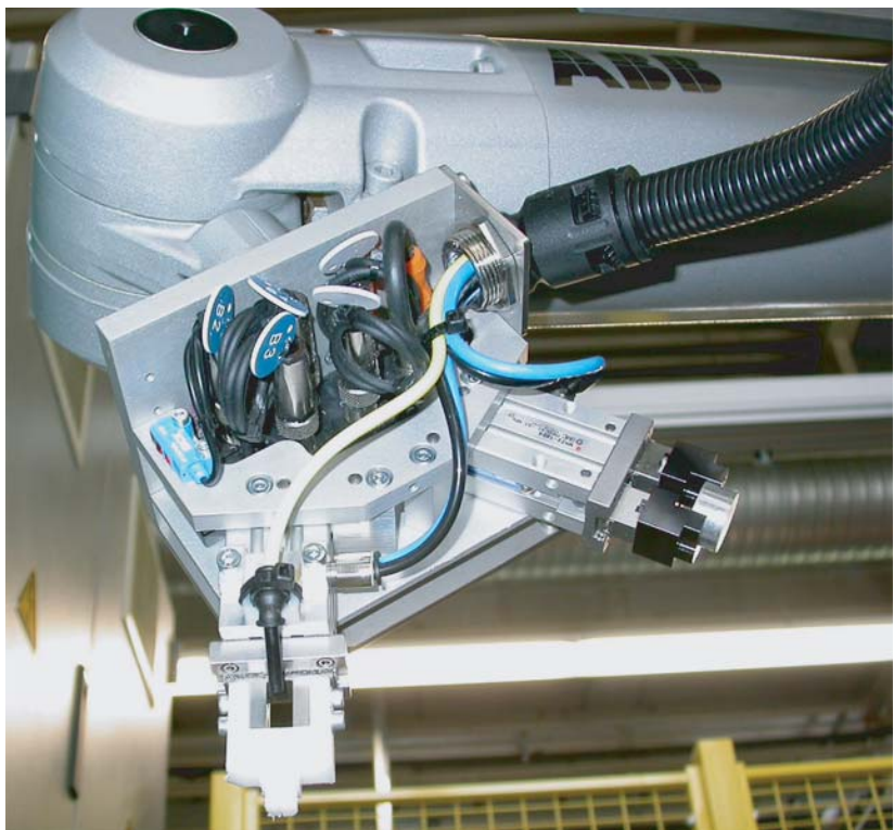
Detailansicht Einlege-/Ent- nahmegreifer.
