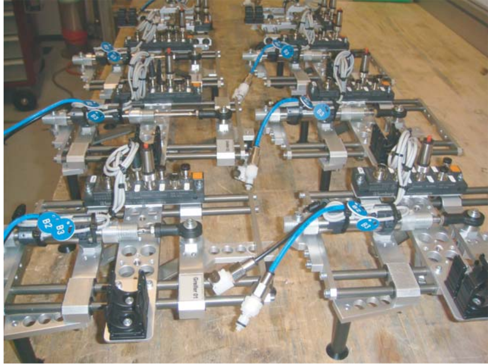
Pickergreifer mit Wechselsystem zum Verpacken von Lebensmitteln.
