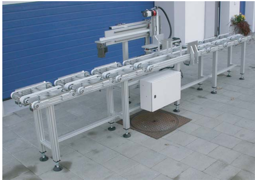
Werkstückträger, Förder- und Umstapel- anlage mit Servoachsen.
