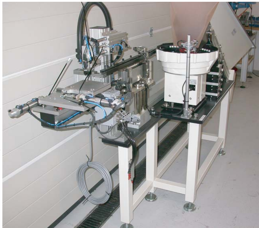
Bereitstellung mit Zuführung und Bunker für Kleinteile.
